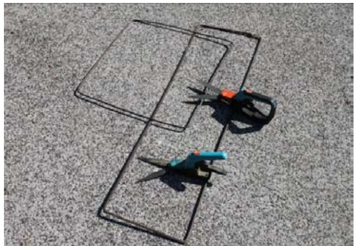
Metalni okviri i škarice za određivanje suhe tvari metodom probnih površina.
